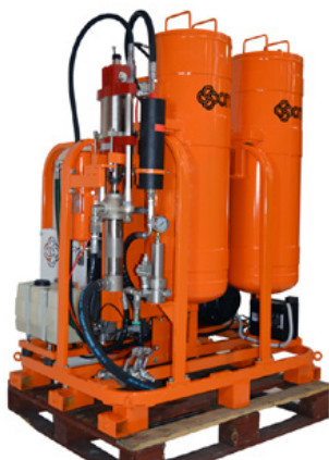
Airless machines voor de platformromp
