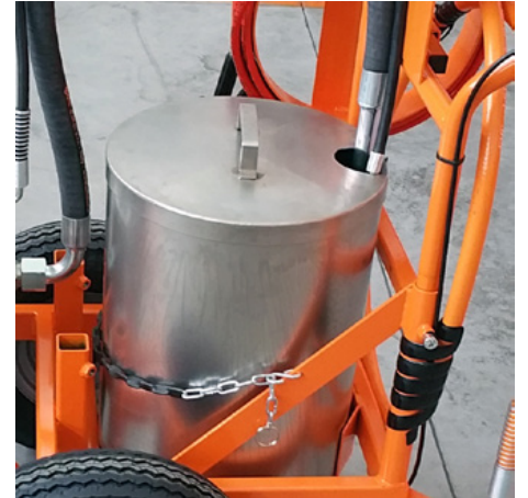
Réservoirs de peinture
